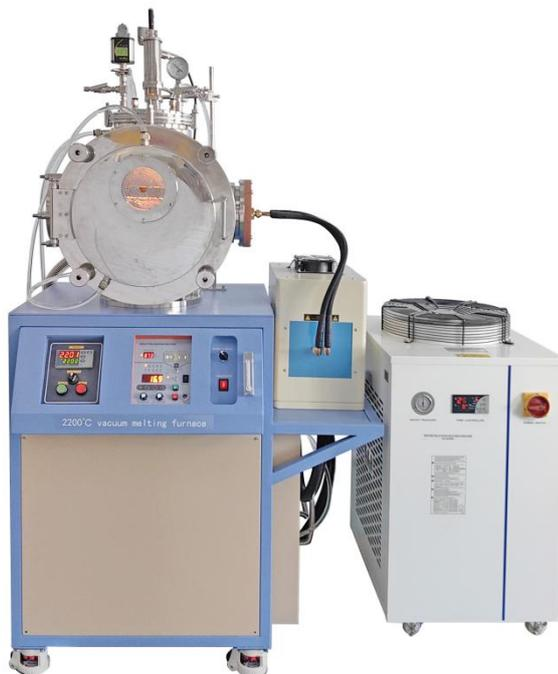
VMC-2200 是一款真空/气氛熔炼炉，此款熔炼铸造炉可熔炼各种合金材料，最高温度 2200℃，最大熔炼量 4KG(按 Fe 计算)。图片仅供参考，请以实物为准
