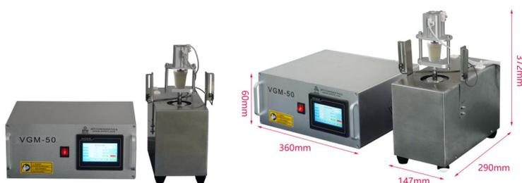
MSK-VGM-50 是一款自动化小型立式研磨机，可对烧结后的陶瓷材料进行破碎，和球磨细化，出料粒径可达 0.1 $\mu$ m，与外部机械手配合可实现完全无人化操作，采用 DC24V 电机驱动，可在 Ar 环境下的手套箱内使用。可适配各种研磨罐：1.5ml 至 25ml，冲击振幅 16mm，最高频率可达 3000 次/分钟。
