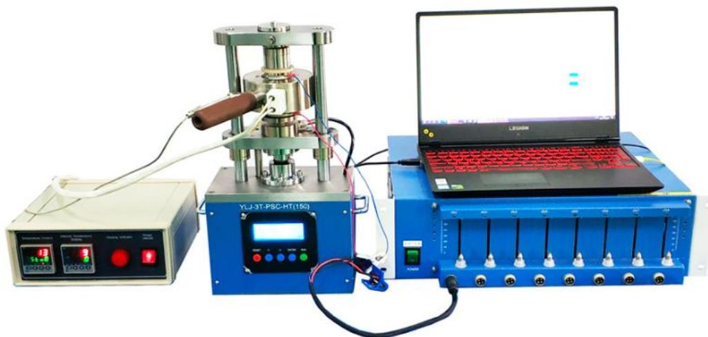
YLJ3TPSCHT 是一款固态电池加热加压充放电测试系统，可研究固态电池在不同温度和压力环境下的电性能。
