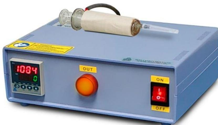
Syringe20-GH 是一款可加热型玻璃注射器，最大温度 200℃，带有精密温控系统，可配合本公司静电纺丝或旋转涂布机使用。
