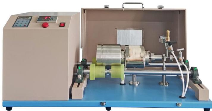
高温滚筒球磨机设备是针对粉碎、研磨、分散、乳化金属、非金属、有机、中草药等粉体进行设计的。特别适合实验室研究使用，其工作原理是在气氛保护下利用磨料与试样在研磨罐内高速翻滚，对物料产生强力剪切、冲击、碾压达到粉碎、研磨、分散、乳化物料的目的。同时通过外部的加热环，实现加热功能，最高加热温度可达 500℃。能很好的实现各种工艺参数要求，模拟生产中的各项指标，同时由于其小批量、低功耗、低价位的优点，是学校、研究单位、公司是进行粉碎工艺、新材料、涂料研究的首选设备。
