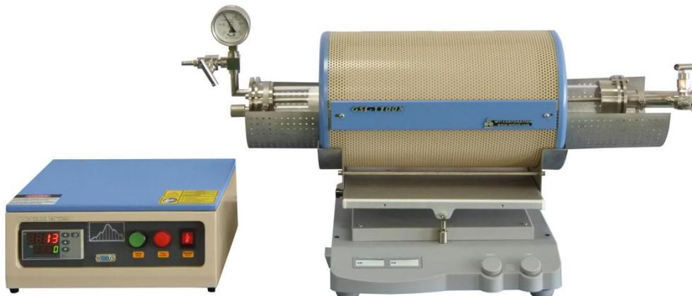
GSL-1100X-SK 是一款可以摇摆的石英管式炉，结构紧凑，用于在加热或熔化过程中混匀样品，反应更均匀。设置好摇摆速度和时间，即可运行。它是制备热电材料和二维晶体生长的绝佳工具。
