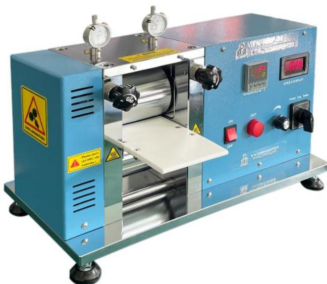
MSK-HRP-01 加热型辊压机专为材料研究人员设计，适合于实验室内电池材料，少量金、银等贵金属、铜、铝等有色材料的手工轧制，轧制厚度可调，操作简单。尤其适合于清洁能源材料锂电池极板的减薄和增大密度。
